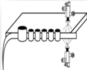
Fluido de limpieza LcM enfría las juntas adhesivas en los cantos. El fluido de limpieza LcM 2/21 se ha diseñado para el uso directo frente a tronadoras. De modo que la cola se enfría a temperatura normal.
