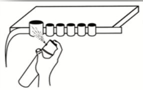
Su ventaja: un proceso de limpieza significativo de la pieza. Con el pulverizador de espray de medio protector Lc las partes tratadas pueden, posteriormente estamparse, corregirse, pintarse o similar.
